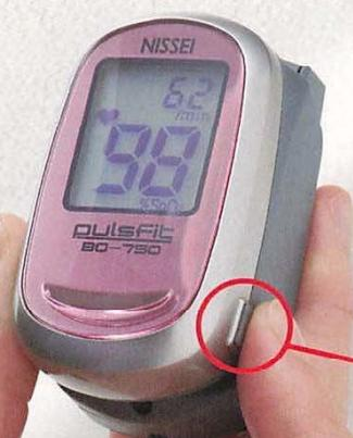
「メモリー機能」を搭載しているので、表示が消えてもボタンを押せば最終測定値が表示されます。また、指周囲30～66mmまで測定できるので6歳から成人まで対応可能です。
