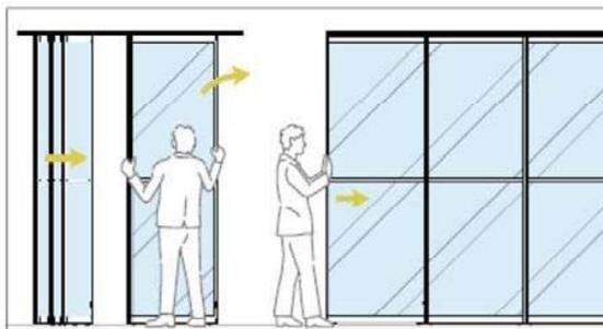
格納部からパネルを順次引き出してレールに沿って移動し、操作はパネル下部のキャスターにより、スムーズにできます。
