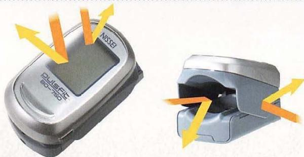
いつでも消毒できるように表示窓部はUVコーティングで耐薬品性を高め、受発光窓部は一体成形で継ぎ目をなくし薬剤の内部への侵入を防いでいます。医療機関などで使用される代表的な薬剤12種類で耐久性を確認しました。※当社評価方法による。
