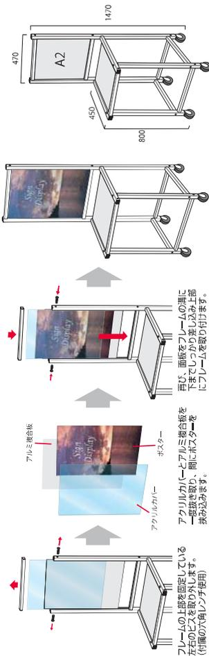
フレームの上部を固定している左右のビスを取り外します。(付属の六角レンチを使用) アクリルカバー アクリル複合板 ホスター
